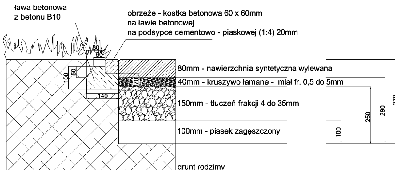
Rys. 13 Przygotowanie podbudowy z kruszywa pod nawierzchnię syntetyczną wylewaną grubości 80mm (dla wysokości swobodnego upadku do 2,6m).
